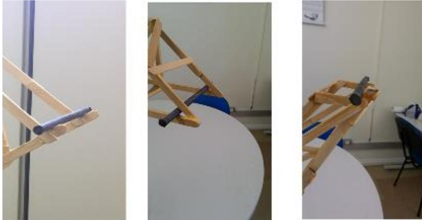
Figura 2 - Detalhe de exemplos no ponto de aplicação da carga.
