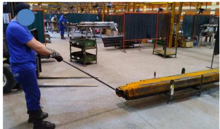
Figura 1: Simulação da operação de desmontagem da lança do kit.
