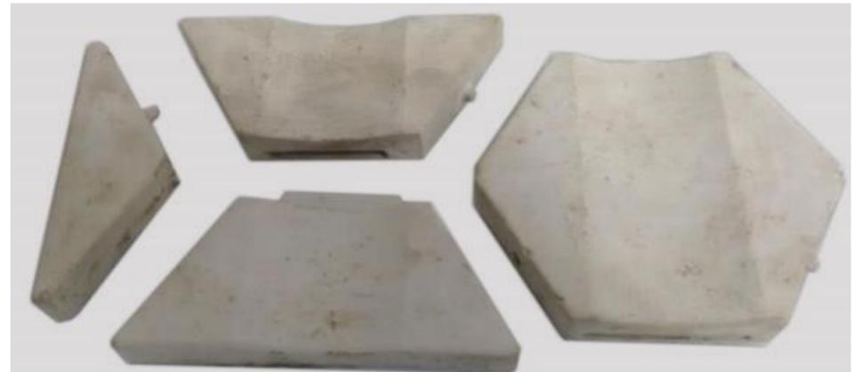
Figura: Peça desenvolvida com cimento-serragem/pó
