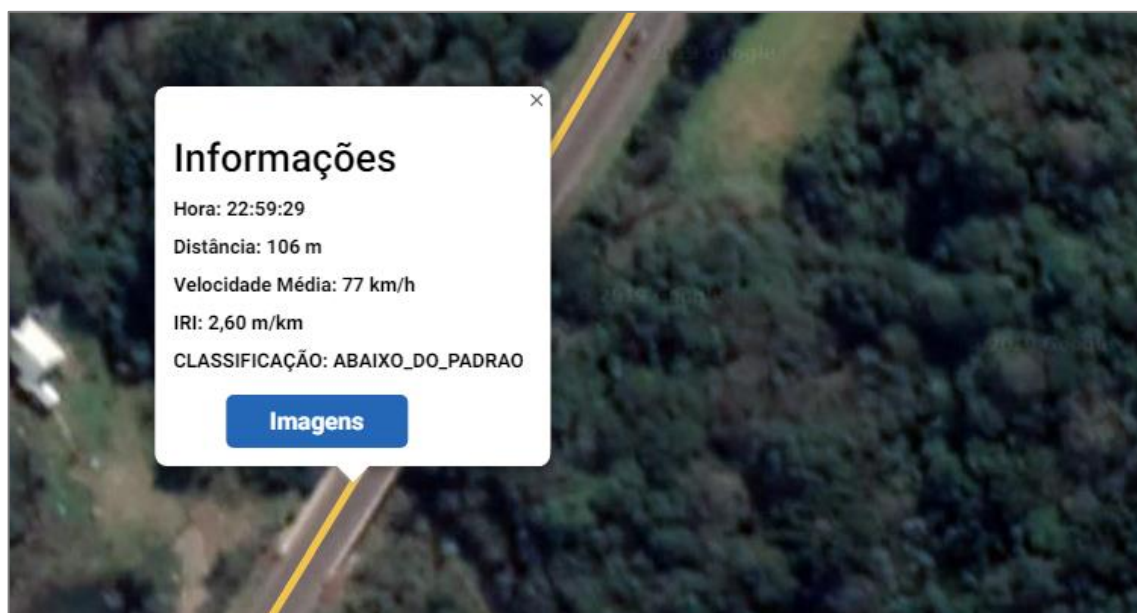
Figura 126: Resultado do IRI na Ponte 7.
