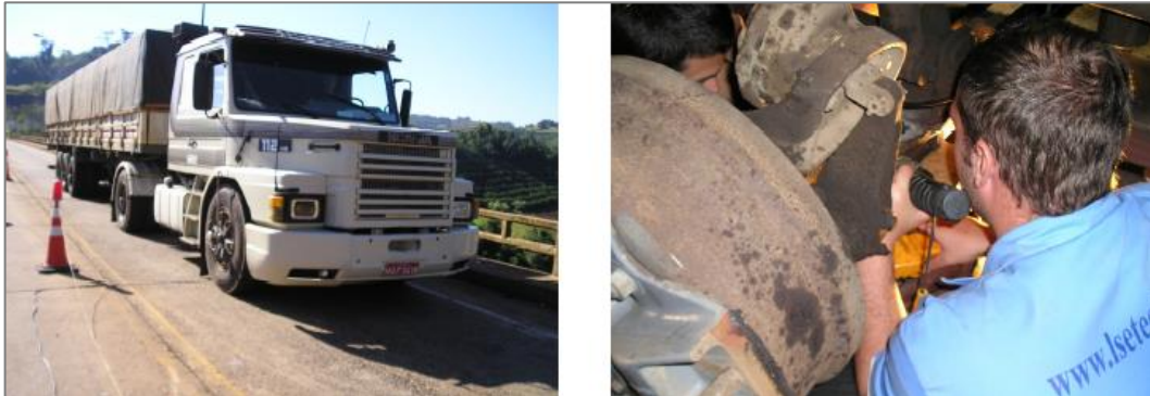
Figura 24: Veículo empregado nos ensaios dinâmicos e equipamento instalado na suspensão do mesmo.
