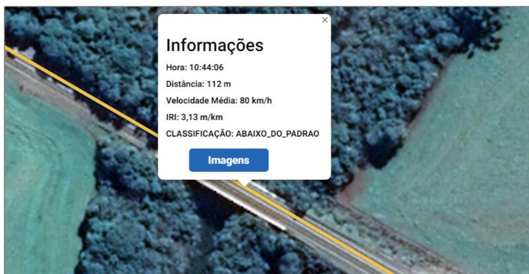
Figura 89: Resultado do IRI na Ponte 3.
