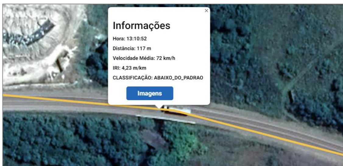
Figura 59: Resultado do IRI na Ponte 1.
