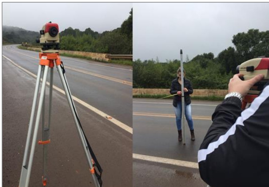
Figura 46: Execução do Método de Nível e Mira na Ponte 1.
