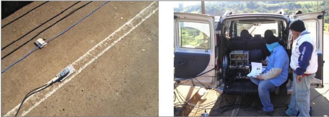
Figura 27: Servo-acelerômetro posicionado na ponte e sistema de aquisição de dados utilizado para a aquisição de dados.
