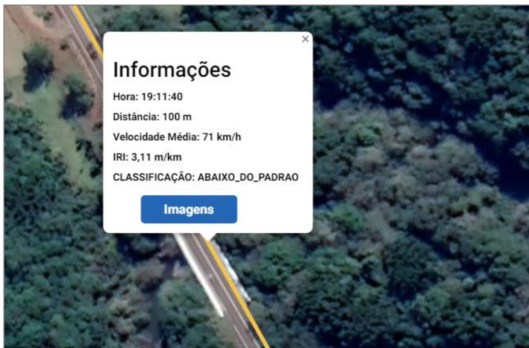
Figura 99: Resultado do IRI na Ponte 4.
