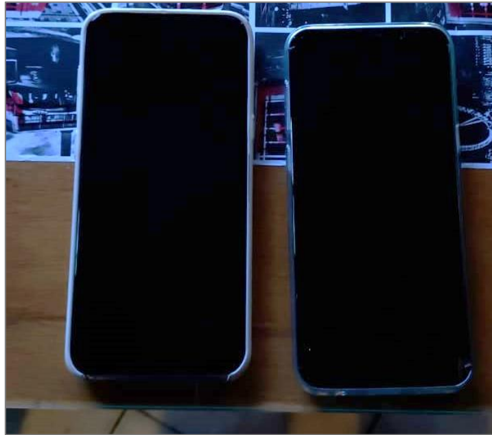
Figura 36: Os dois smartphones utilizados: um no interior do veículo e outro no tabuleiro da ponte.
