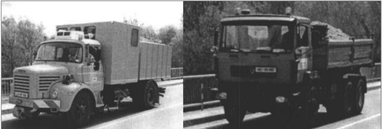
Figura 12: Veículos de carga utilizados para os ensaios dinâmicos em pontes por Brady et al (2006), e também os mais frequentes em rodovias brasileiras: a) veículo dois eixos (2C) e b) veículo três eixos (3C).
