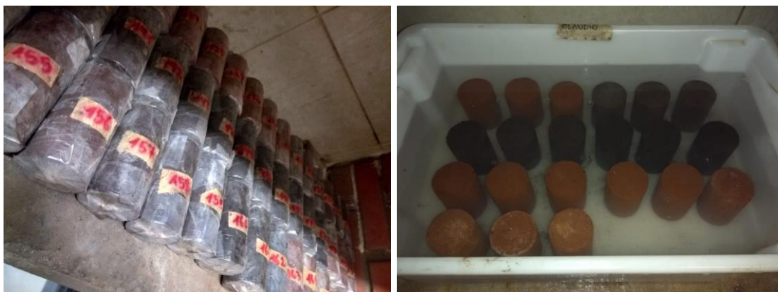
Figura 7: Corpos de prova cilíndricos durante (a) cura na câmara úmida; (b) imersão em água
