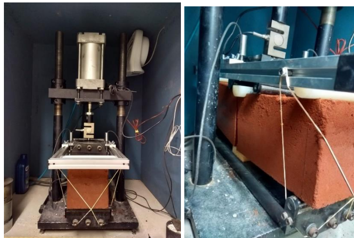
Figura 14: (a) Equipamento montado para iniciar o ensaio; (b) Corpo de prova após a ruptura
