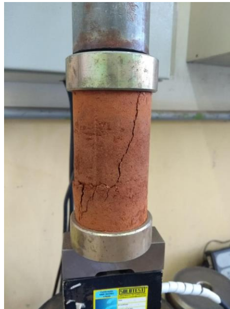
Figura 9: Ruptura do corpo de prova à compressão simples
