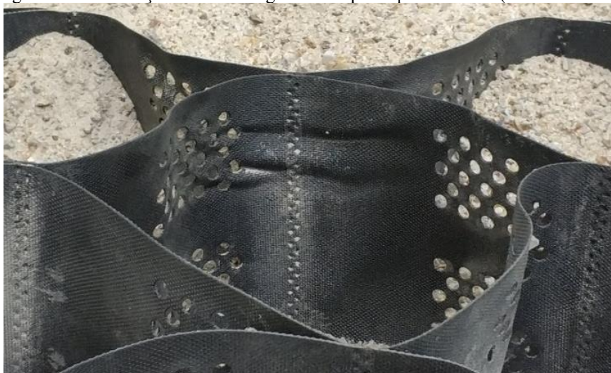
Figura 54: Deformação ocorrida na geocélula após ruptura do solo (Ensaio SG1 20)
