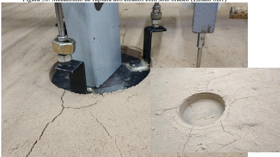
Figura 30: Mecanismo de ruptura dos ensaios com solo branco (Ensaio SB1)
