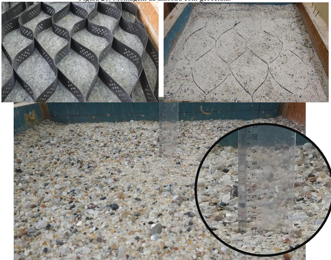
Figura 21: Montagem da amostra com geocélula.
