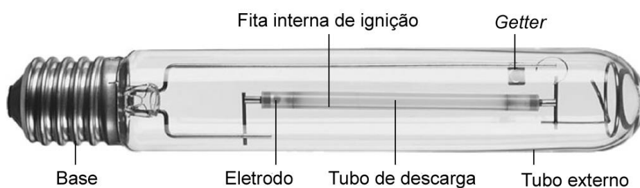
Figura 2: Componentes de uma lâmpada de vapor de sódio em alta pressão.
