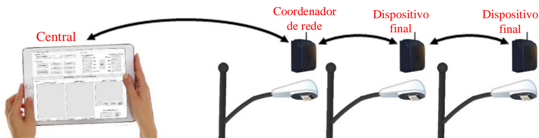
Figura 14: Funcionamento do sistema de telegestão.
