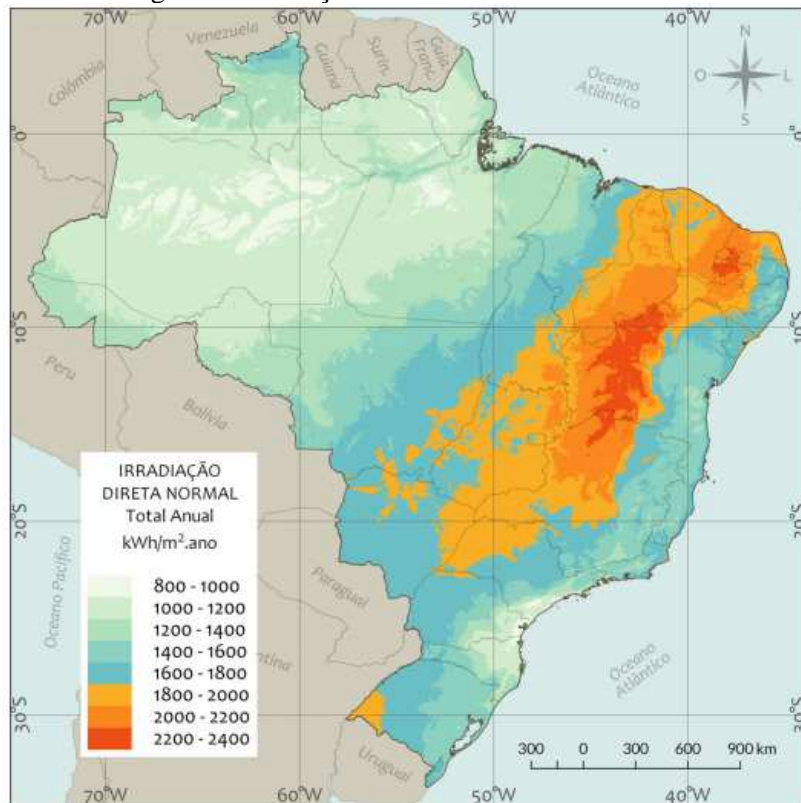
Figura 4 - Radiação solar média anual no Brasil.
