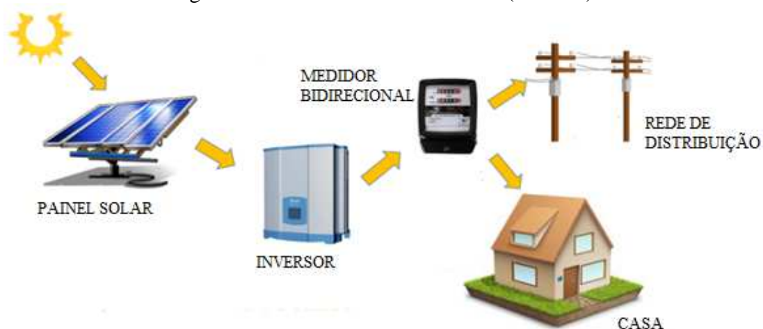
Figura 18 - Sistema conectado a rede ( Grid-tie ).
