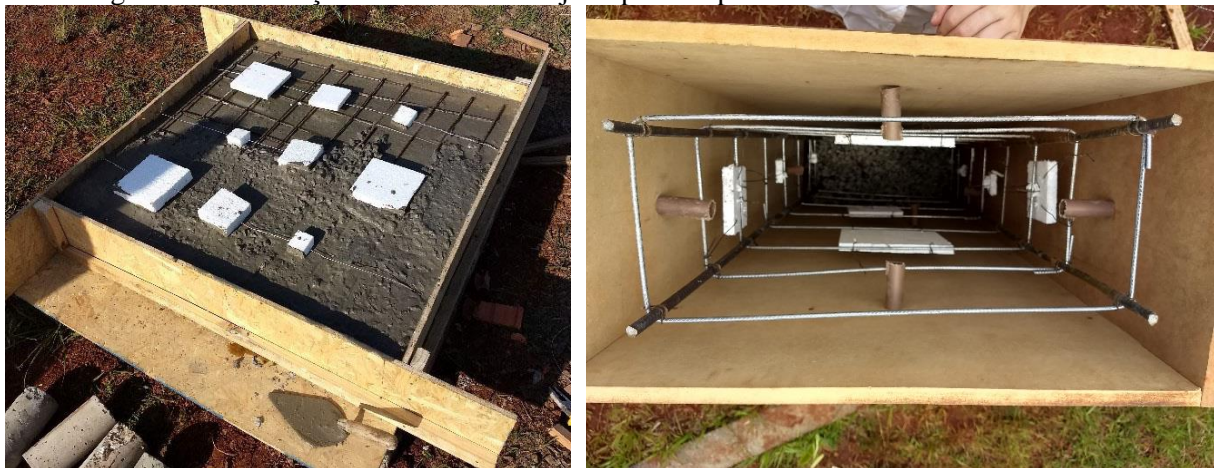
Figura 23- Construção de amostras de lajes e pilar de ponte -Posicionamento dos defeitos
