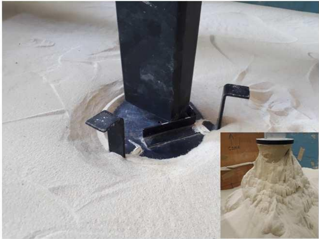
Figura 61: Ruptura do material para ensaios com solo de base (referência - E0 e E1).
