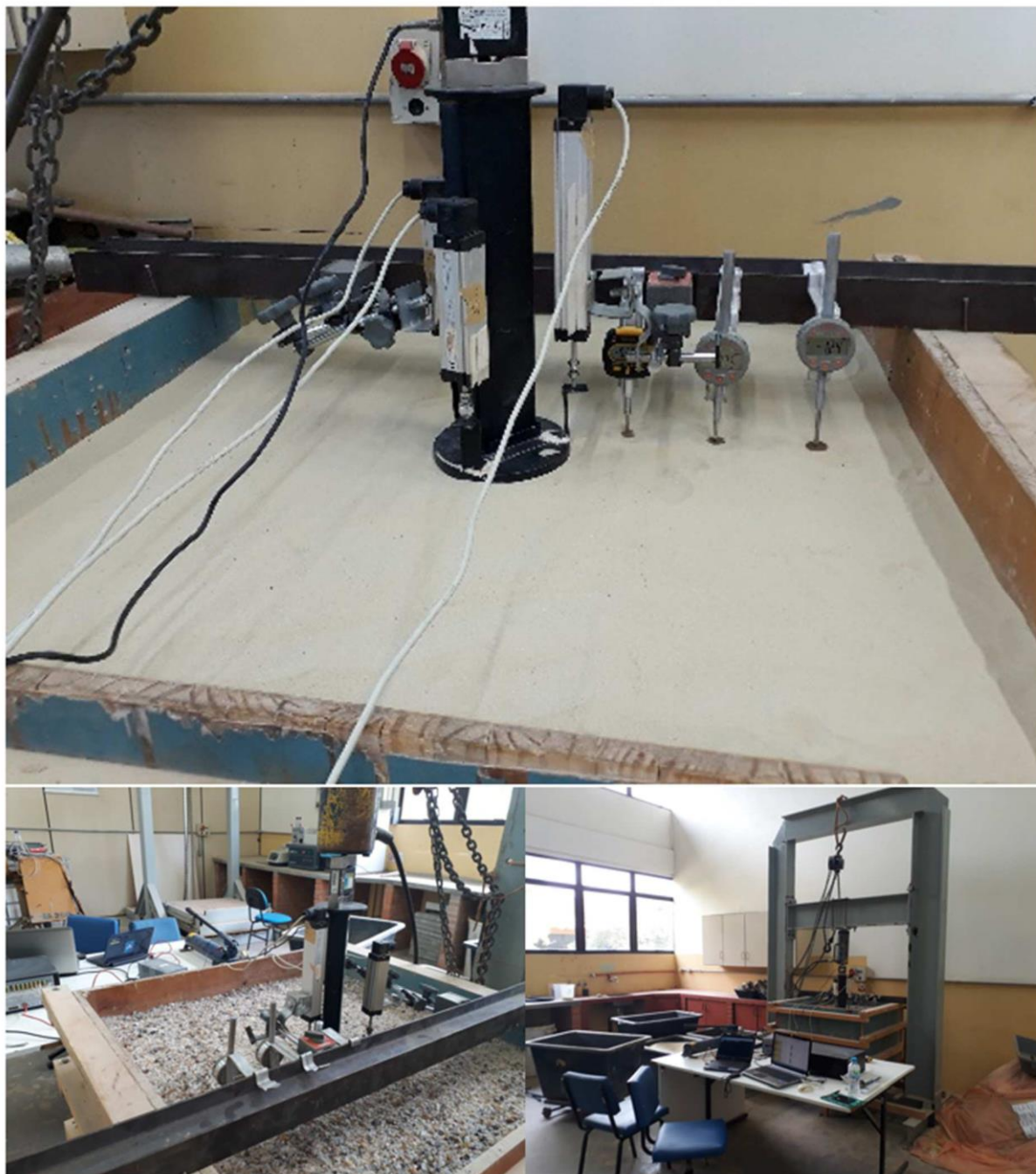
Figura 20: Ensaio de placa.
