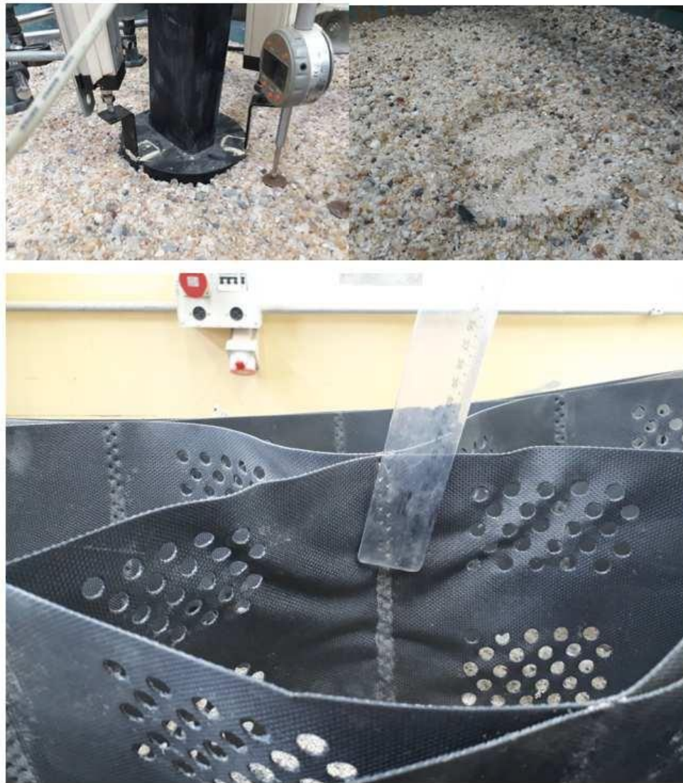
Figura 62: Ruptura do material para ensaios com geocélula.
