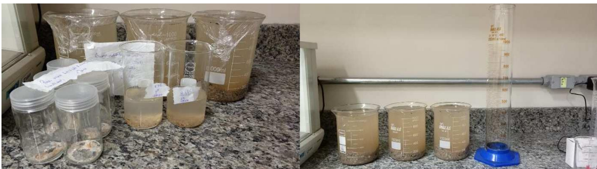
Figura 12: Ensaio de Lixiviação e Solubilização
