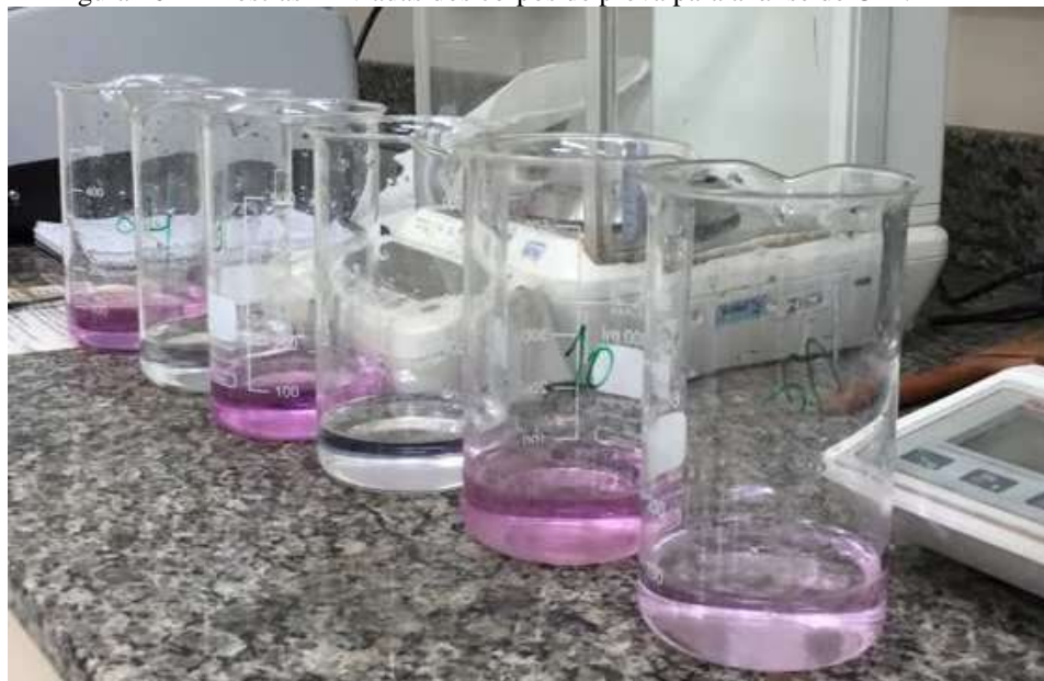
Figura 16 - Amostras lixiviadas dos corpos de prova para análise de \text{Cr}^{6+} .
