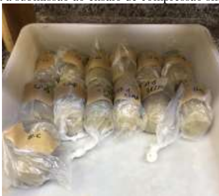
Figura 18 - Amostras para a submissão ao ensaio de compressão simples aos 28 dias.
