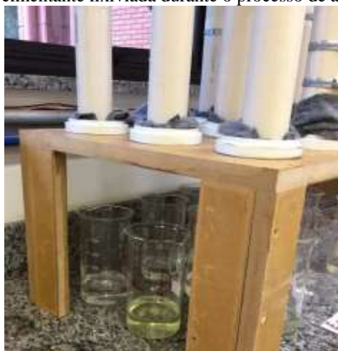
Figura 15 - Coleta da solução biocimentante lixiviada durante o processo de aplicação da solução biocimentante.
