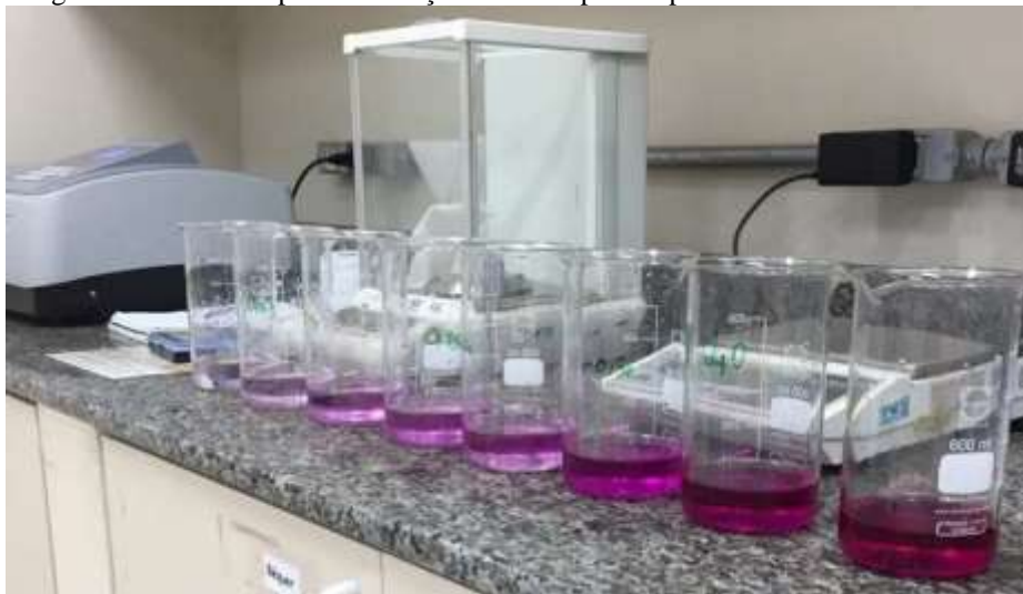
Figura A - Amostras para construção da curva padrão para análise de \text{Cr}^{6+} .
