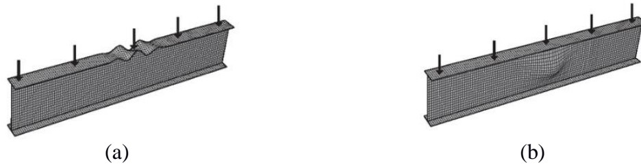
Figura 7: Flambagens locais de vigas com perfis I fletidos: (a) Flambagem local a mesa comprimida (FLM) e (b) Flambagem local da alma (FLA).
