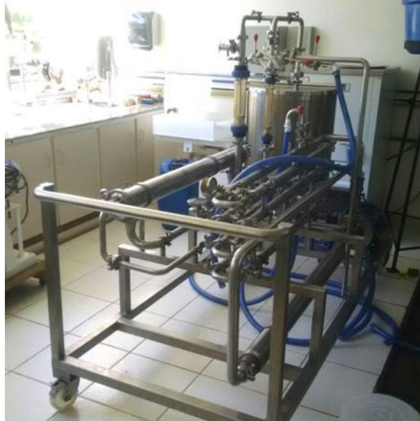
Figura 16: Equipamento piloto do sistema de membranas para osmose inversa, utilizado para tratar a água residual de Spirulina platensis .
