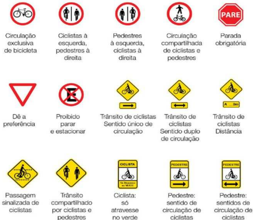
Figura 41 – Placas de sinalização voltadas ao transporte cicloviário
