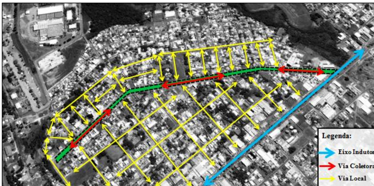
Figura 72 – Entorno do Parque do Sétimo Céu: parcelamento do solo, hierarquia e fluxos viários.
