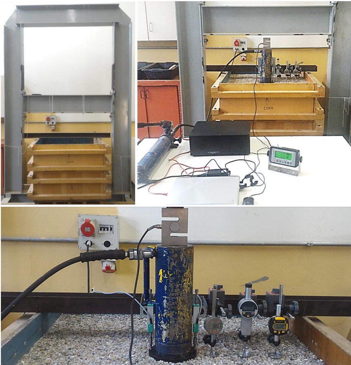
Figura 17: Configuração completa dos ensaios de placa.
