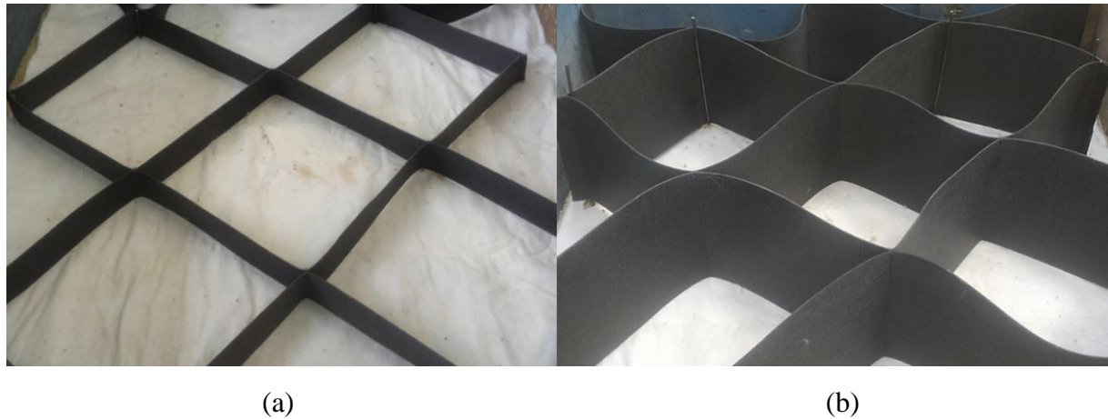
Figura 15: Geocélulas utilizadas (a) h = 5 cm (b) h = 20 cm.
