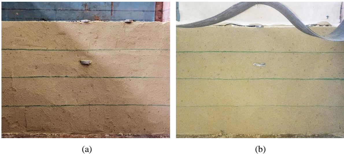
Figura 40: Exumação das camadas de areia subjacente a uma camada de 20 cm de resíduo (a) sem reforço SR-20, (b) com reforço GCE-20.
