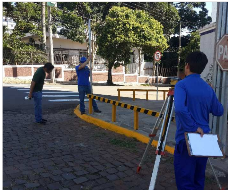
Figura 40 – Nivelamento geométrico duplo.
