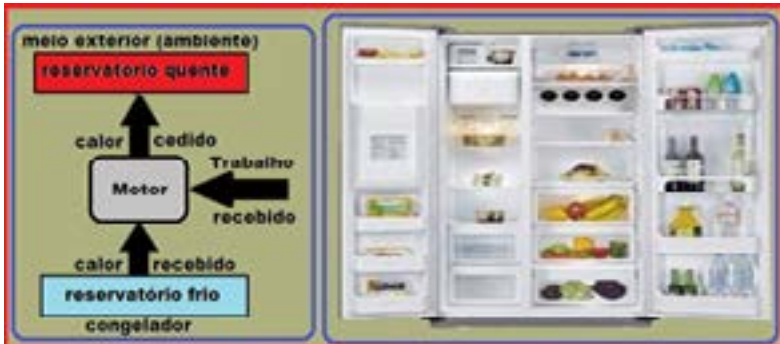
Figura 10 – Funcionamento de uma máquina frigorífica.
