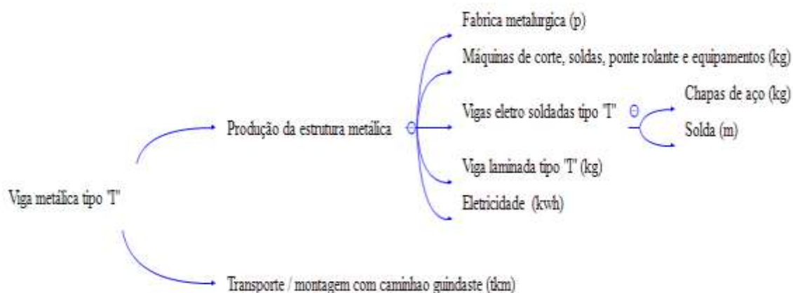
Figura 21 - Fluxograma de processos e produtos avaliados na produção de vigas metálicas tipo “T” Fonte: Produzido pelo autor (2019)
