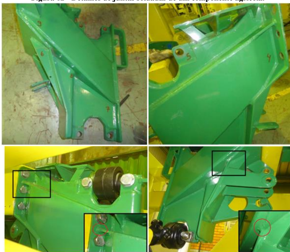
Figura 62 - Detalhes de juntas soldadas de um componente agrícola.
