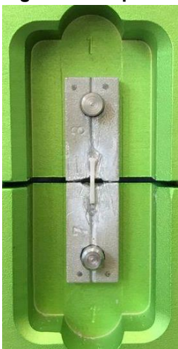
Figura 14: Amostra fixada no dispositivo de microtração.
