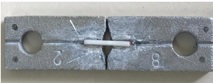
Figura 13: Aspecto visual das amostras após secção: obtenção dos palitos
