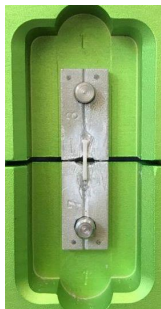
Figura 5: Amostra fixada no dispositivo de microtração.
