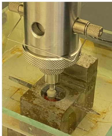
Figura 8. Posicionamento dos CP em máquina de ensaios universal durante o teste de compressão.
