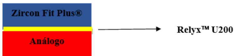
Figura 7- Desenho esquemático da cimentação Zircon Fit Plus® + CRaut RelyxU200® + Substrato (CRFV).
