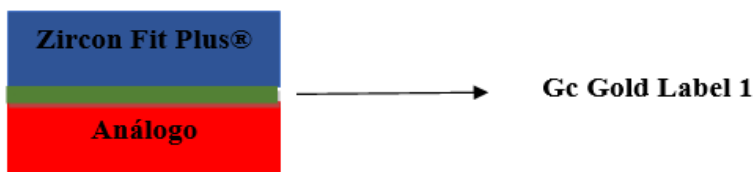
Figura 9- Desenho esquemático da cimentação Zircon Fit Plus® + CIV GC Gold Label 1 + Substrato (CRFV).
