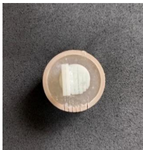
Figura 17- Tentativa de secção dos palitos para o ensaio de microtração.
