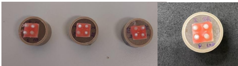
Figura 14- Cimentação dos corpos de prova de zircônia para o teste de microcisalhamento.
