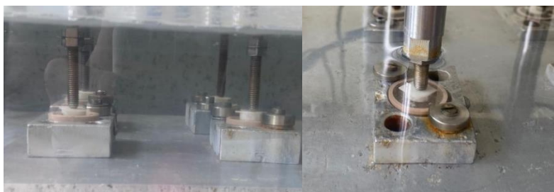
Figura 15- Teste de envelhecimento mecânico por ciclagem.
