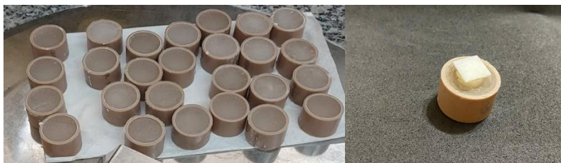
Figura 10- Confeção dos tubos com resina acrílica, seguida da fixação do conjunto cimentado.
