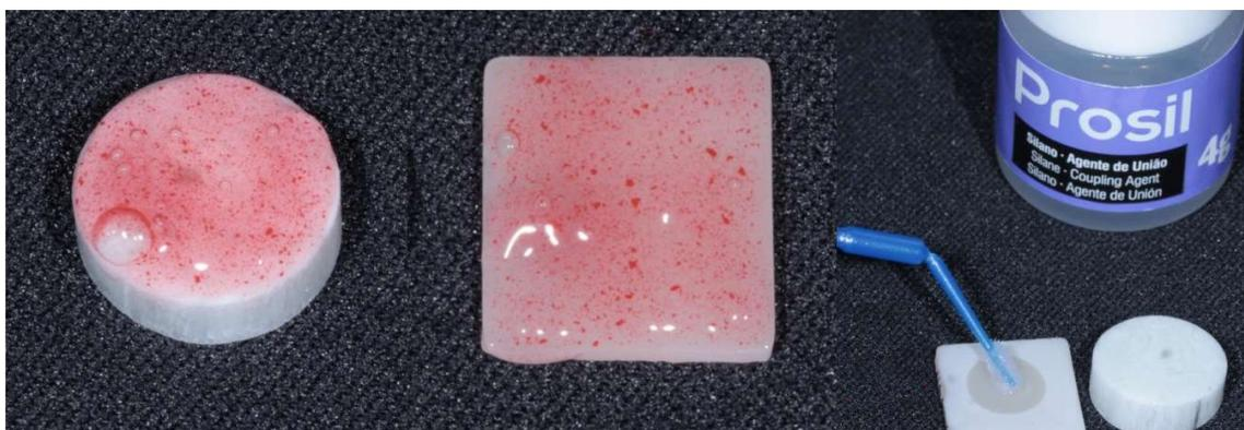
Figura 3 - Tratamento do substrato do análogo e da PICN, e aplicação do silano.
