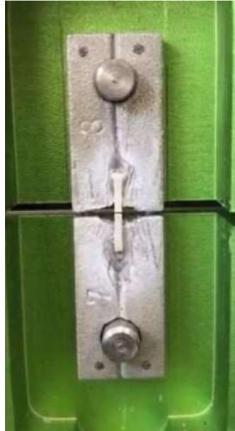
Figura 10 - Ensaio de microtração.
