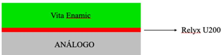
Figura 5 - Desenho esquemático do corpo de prova com PICN/RelyX U200/ANÁLOGO.
