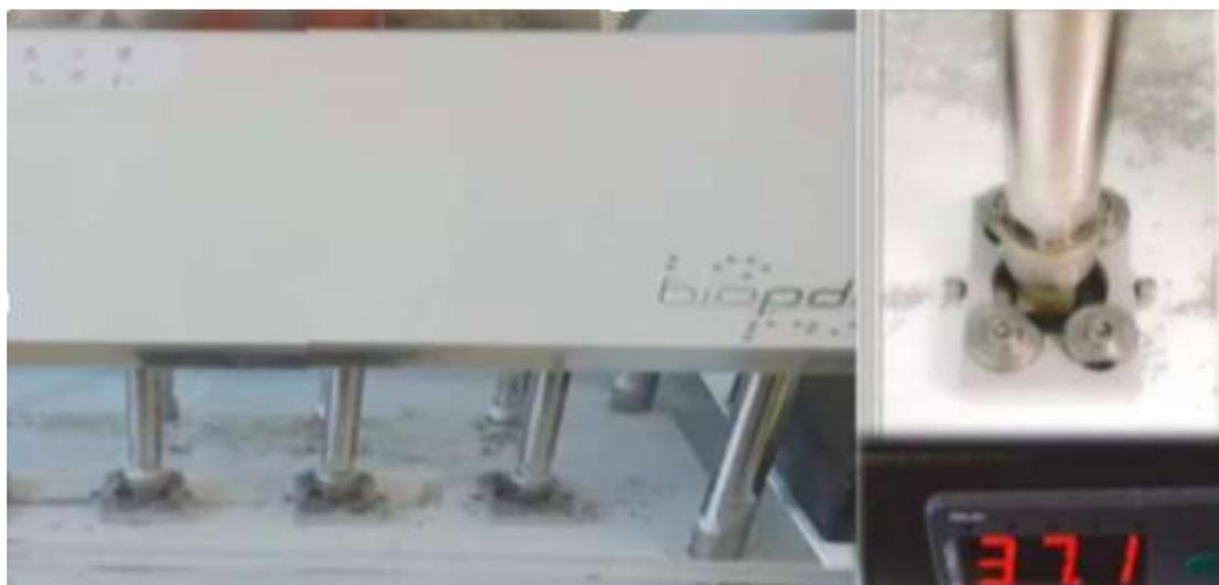
Figura 8 - Teste de envelhecimento mecânico por ciclagem em água com temperatura de 37.1°C.
