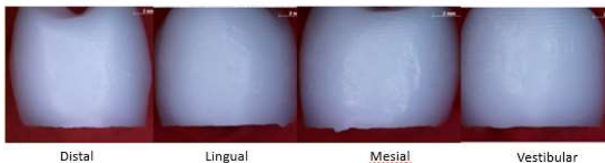
Figura 7: Margens de todas as regiões de uma coroa usinada em protocolo rápido.
