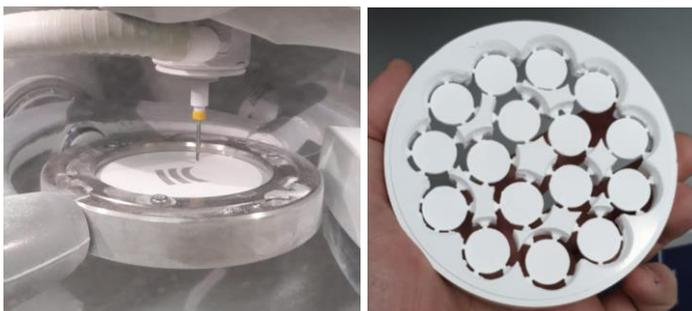
Figura 1. Processo de usinagem da zircônia na fase verde.
