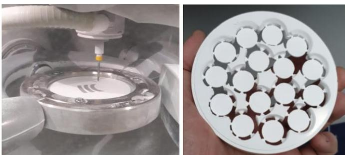
*Figura 2. Processo de usinagem da zircônia na fase verde.*
