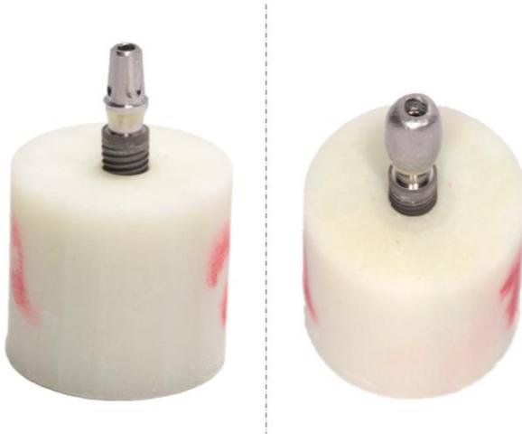
**Figura 6.** Amostra aleatória do grupo PS1 (esquerda) e amostra com protetor de metal fundido posicionado sobre o pilar (direita).
