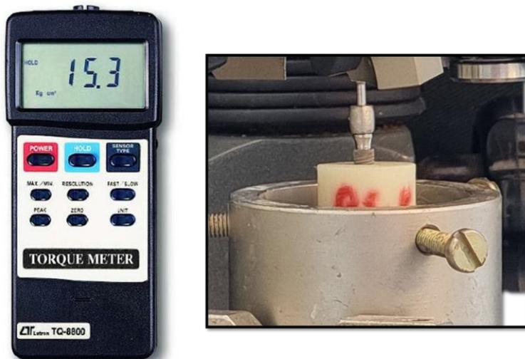
**Figura 5.** Torquímetro digital utilizado e posicionamento do corpo de prova em delineador para manejo do torque nos pilares de forma paralela e padronizada.
