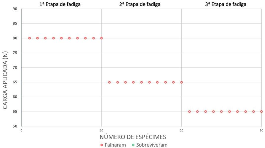
**Figura 9.** Carga aplicada em função do afrouxamento de pilares com parafuso passante (PP) durante as etapas de ciclagem.
