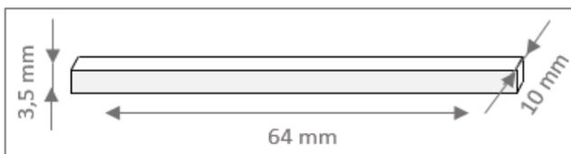
*Figura 2. CPs em forma de barra para os testes de flexão e módulo de elasticidade*
