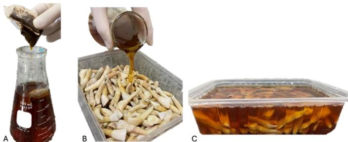
Figura 1 . Protocolo de escurecimento dos corpos de prova: A- preparo da solução de chá preto; B- imersão dos corpos de prova na solução; C- armazenamento dos corpos de prova.
