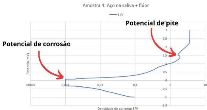
Figura 7: Gráfico da amostra 04 do grupo 4 (Aço na saliva artificial+flúor), onde mostra potencial de corrosão (0,06) e potencial de pite (1,34).
