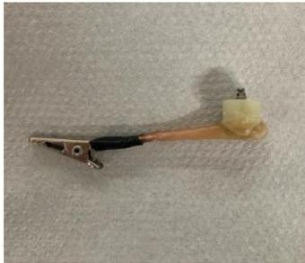
Figura 1: Mini-implante inserido no Nema G10, com sua cabeça e transmucoso expostos. Toda porção onde continha cobre isolada com cera de abelha.
