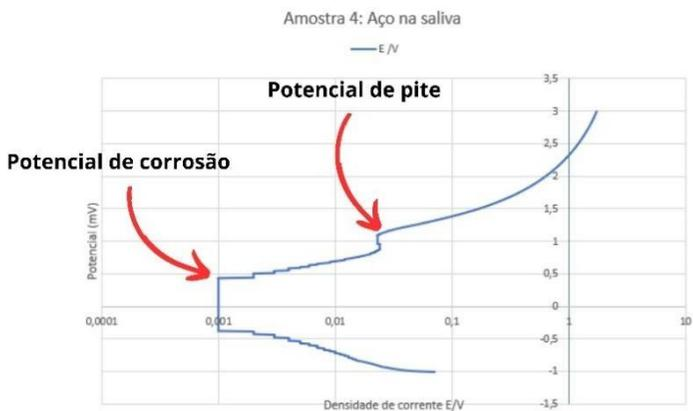
Figura 5: Gráfico da amostra 04 do grupo 3 (Aço na saliva artificial), onde mostra potencial de corrosão (0,32) e potencial de pite (0,88).
