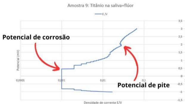
Figura 11: Gráfico da amostra 09 do grupo 6 (Ti6Al4V na saliva artificial+flúor), onde mostra potencial de corrosão (0,76) e o potencial de pite (1,92).
