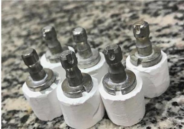
Figura 2. Obtenção de cilindros de zircônia não sinterizadas para posterior corte em discos.
