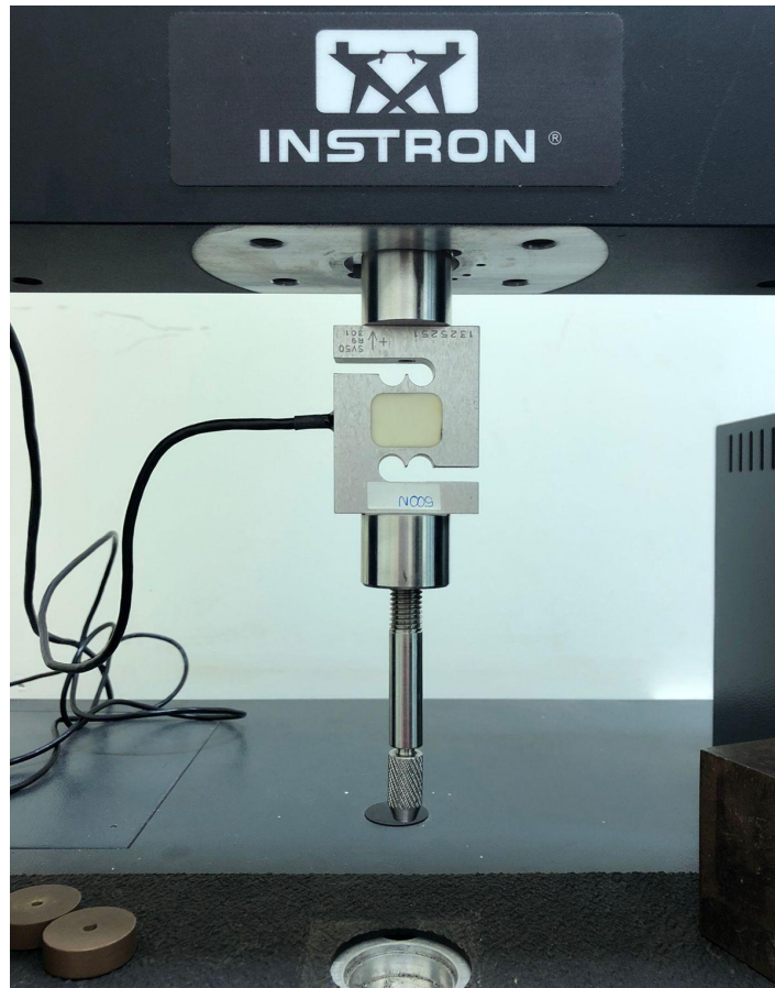
Figura 10 - Vista do dispositivo de teste PO acoplado à máquina universal de ensaios.
