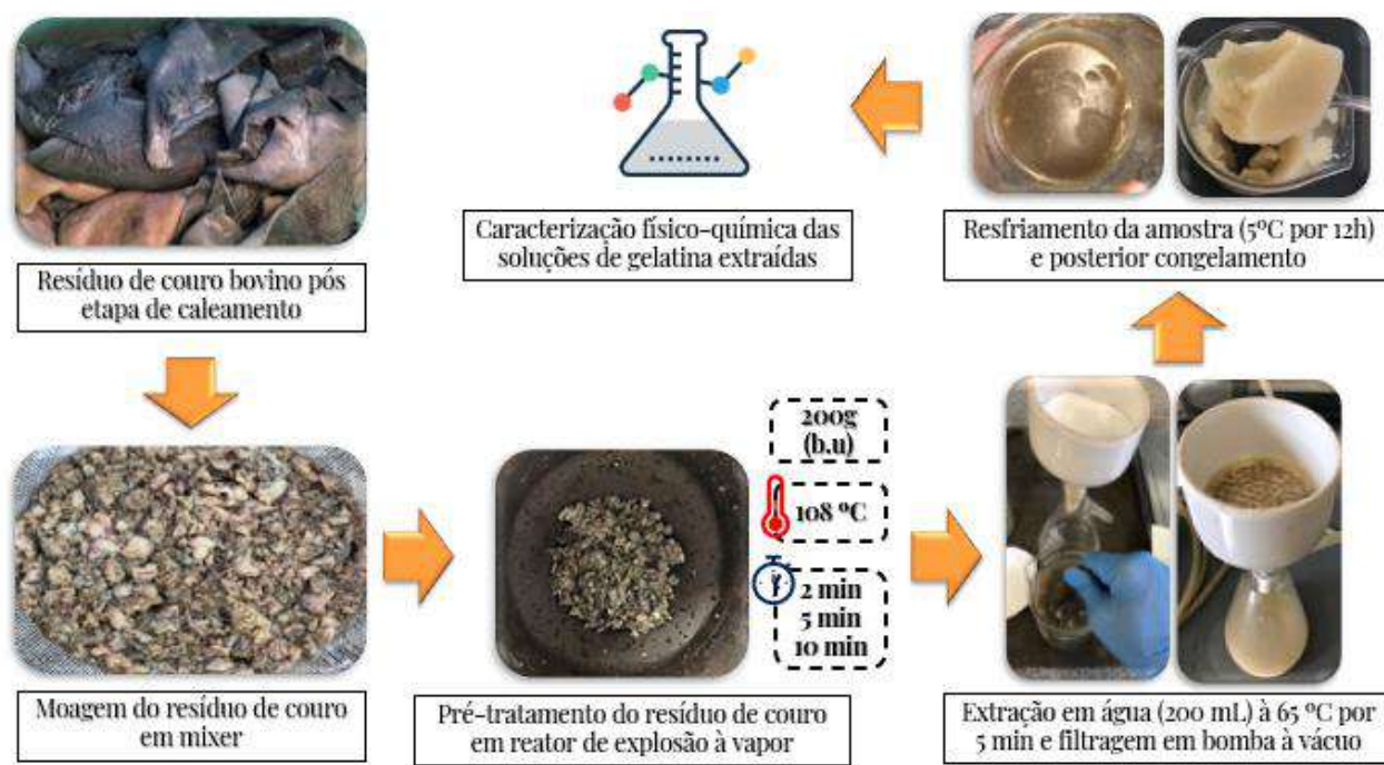
Figura 1: Etapas do pré-tratamento de pele bovina por explosão a vapor para extração de gelatina.
