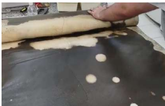
Figura 9: Membrana colmatada após uso.
